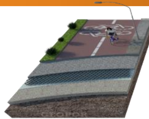
GEOPOR Hücresel Dolgu Sistemi Temel destek ve takviye katmanı
